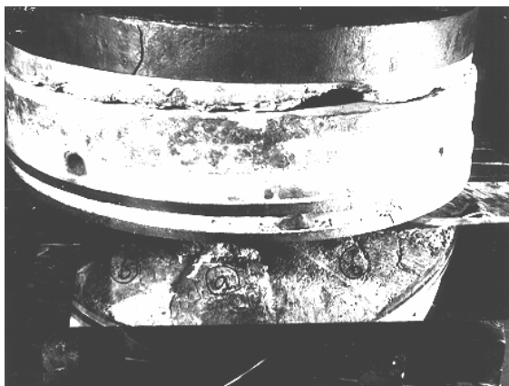
Fig. 6. Ferecătura de tip francez a pietrelor de moară: a) - zone cu silicifieri; b) - zone ferecate (șanturi radiale)
