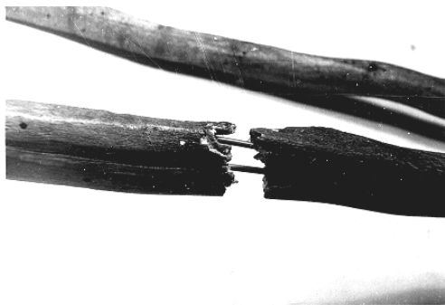
Fig. 13.b. Detalii din timpul restaurării; tije și știfturi din metal inoxidabil folosite pentru reconstituirea zonelor fracturate cu pierderi de material lemnos
