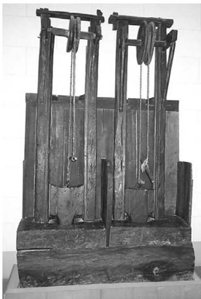
Fig. 11. Teasc cu chilugi (acționați pe scripeți)
