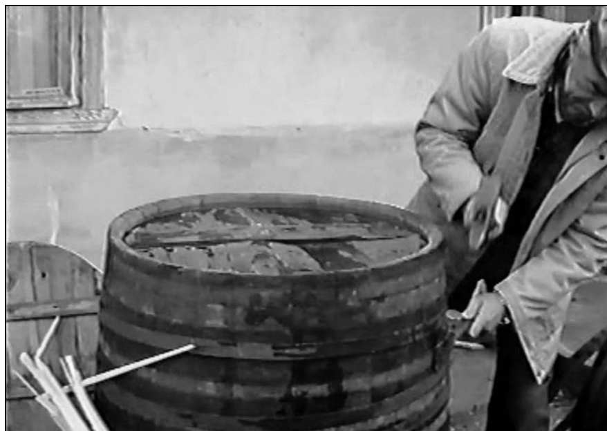
Fig. 28. Bătutul cercurilor în Condrîța – Strășeni (2005)
