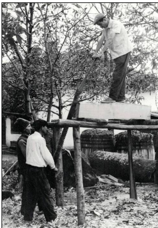
Fig. 2. Tăiatul lemnului pentru roți cu trașca (Boghicea – Neamț; 1966)
