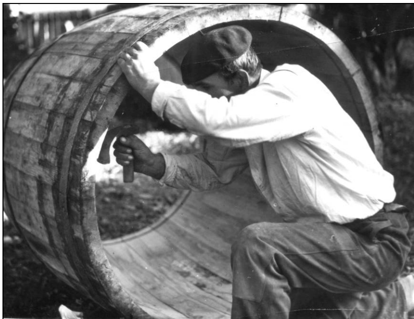
Fig. 29. Tesluitul butoiului la Boghicea – Neamț (1966)
