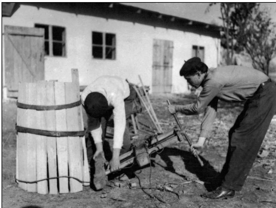
Fig. 21. Strânsul butoiului cu șurubul la Boghicea – Neamț (1966)
