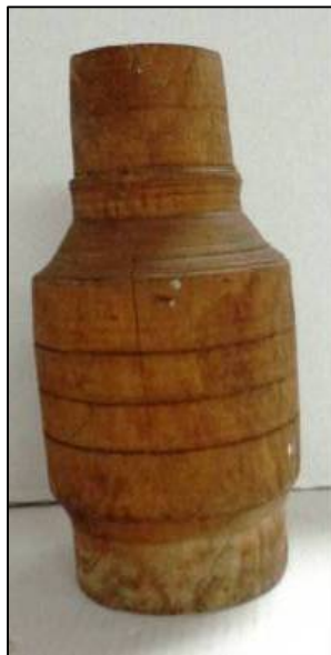
Fig. 13. Măsură „pentru măsurat butucul și dat semne”
