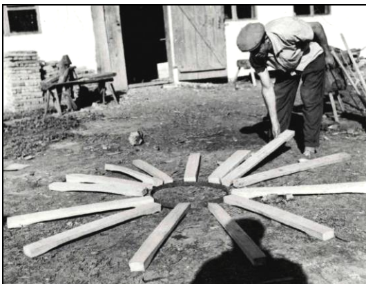
Fig. 5. Înșiratul doagelor la Boghicea – Neamț (1966)
