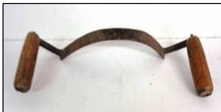
Fig. 12. Cuțitoaie curbă sau teslă de coveti
