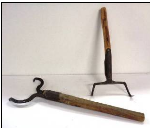
Fig. 25. Gheară pentru butnărit și scoabă de tras doagele la păpurit butoaie
