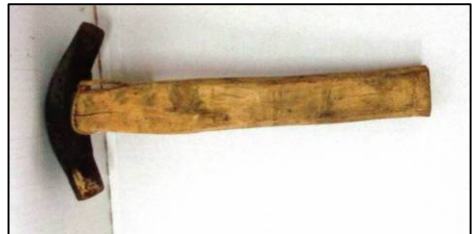
Fig. 11. Teslă de scobit coveți
