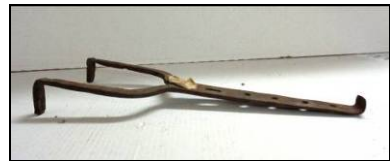
Fig. 26. Potcoavă de tras cercuri la butoaie
