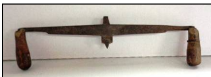
Fig. 16. Cuțitoaie de făcut profile pe scânduri
