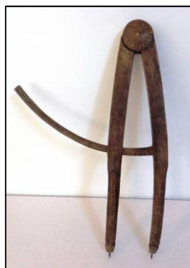
Fig. 17. Compas pentru măsurat roțile de căruță
