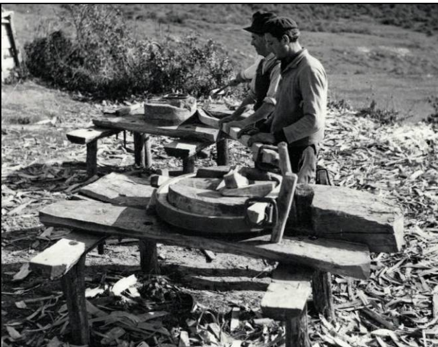
Fig. 26. Faze de lucru din obădărit (Chichirdic, Stănița – Neamț; 1966)
