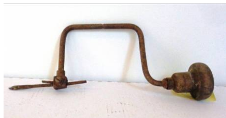
Fig. 25. Coarbă sau curbină de dat găuri
