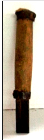
Fig. 8. Bițic, bățic sau bitic de bătut cercurile
