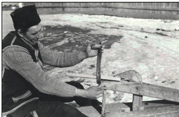
Fig. 4. Trasul doagelor la scăunoaie în Bogata – Suceava (1973)
