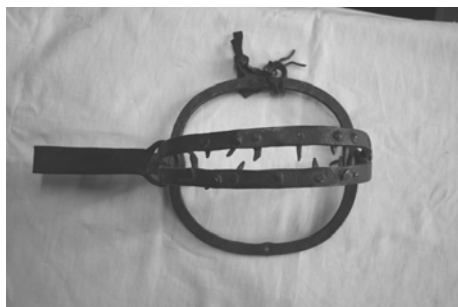
Fig. 5. Curse din fier pentru prins jderi și lupi provenind din Pârâul Fagului – Neamț. Se observă pârghia de susținere a arcului și dinții de pe ambele laturi ale capcanei, precum și suportul de tablă pentru momelă.
