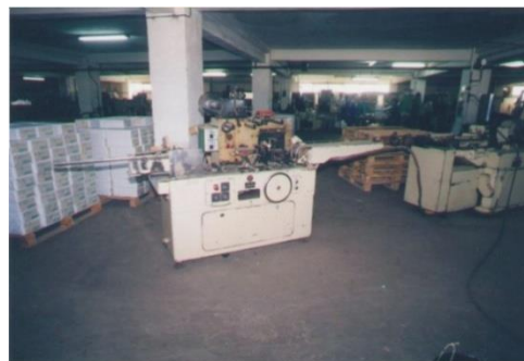
Mașină de împachetat țigarete cu filtru „Skoda” Cehoslovacia, 1970
