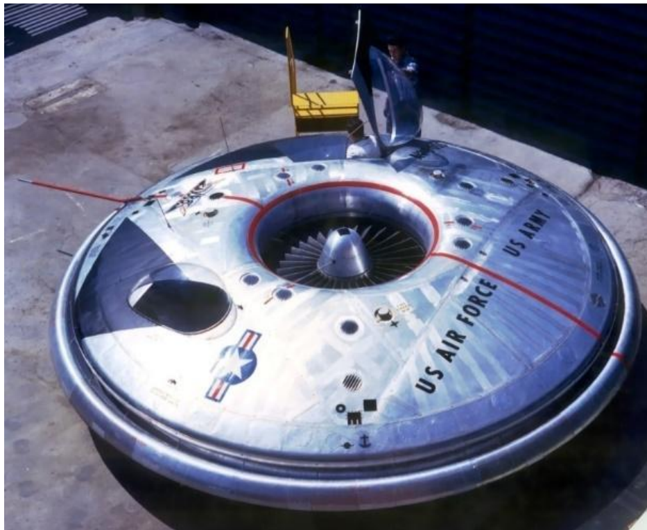
În 1959 a fost realizat vehiculul experimental „VZ-9 Avrocar” care utiliza „Efectul Coandă” pentru crearea portanței
