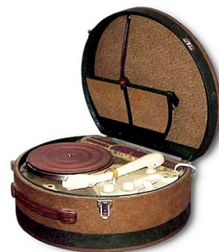
Fig.19. Magnetofon cu pick-up IAUZA Uzina Electromecanică, Moscova, URSS, 1956 Caracteristici: monostereo, două piste, două viteze (19,5 și 8,13 cm/s), 180 m de bandă magnetică, două difuzoare, frecvență: 70-7000 Hz; Material: plastic, piele sintetică, ebonită, metal; Dimensiuni: 62 x 29,5 x 32 cm; Nr.inv.: 4935 Proveniență: Mihăilescu Armand, București, achiziție, 1978; Deținător: Muzeul Științei și Tehnicii „Ștefan Procopiu” Iași
