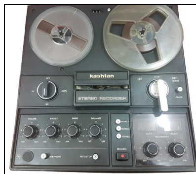
Fig.22. Magnetofon KASHTAN URSS, 1982; Producător: Uzina Communist , Kiev; Caracteristici: vitezele 19.05, 9.53 și 4.76 cm/sec., stereo; Dimensiuni: 40,2 x 44,4 x 19,6 cm; Nr.inv.: 8950; Proveniență: Stavarache Arvinte, Iași, achiziție, 2003; Deținător: Muzeul Științei și Tehnicii „Ștefan Procopiu” Iași
