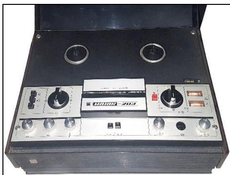
Fig.21. Magnetofon MAJAK model 203 URSS, 1977-1980; Producător: Uzina КАЯК , Kiev; Caracteristici: vitezele 19.05, 9.53 și 4.76 cm/sec.; stereo; Dimensiuni: 43,2 x 33,8 x 16,5 cm; Nr.inv.: 7197; Proveniență: Prepeliță Mariana, Iași, achiziție, 1997; Deținător: Muzeul Științei și Tehnicii „Ștefan Procopiu” Iași
