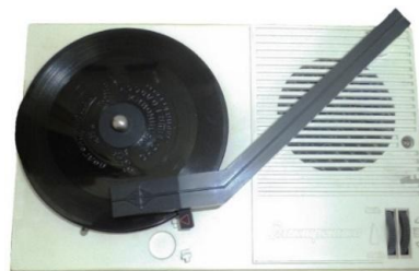
Fig.18. Mini pick-up Elektronika Minsk, URSS, cca.1970 Caracteristici: vitezele 33 și 78 rpm Material: plastic, metal; Dimensiuni: 20 x 12 x 5 cm; Nr.inv.: 8942 Proveniență: Vătavu Georgeta, Iași, achiziție 2006; Deținător: Muzeul Științei și Tehnicii „Ștefan Procopiu” Iași
