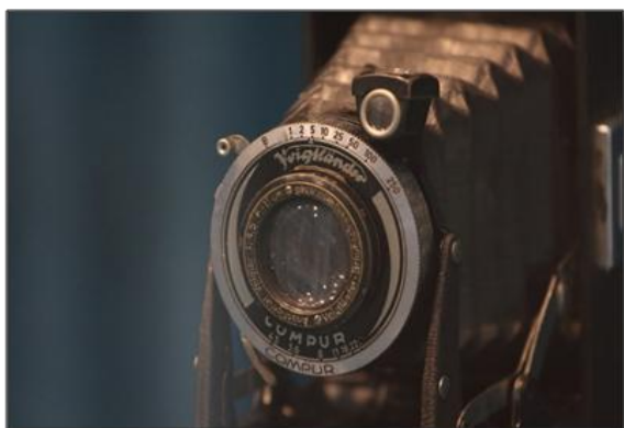
Aparat de fotografiat Voigtlander - Bessa 66, pliabil, 6x6, 1938, rollfilm de 120 mm.
