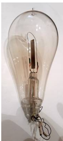
Fig. 2. Tub electronic „Efectul Edison”, considerat cel mai vechi tub cu vid, construit în 1885 pentru profesorul Ambrose Fleming, (sursa: http://www.r-type.org/exhib/aag0124.htm ).
