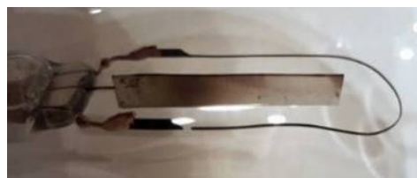
Fig. 2. Tub electronic „Efectul Edison”, considerat cel mai vechi tub cu vid, construit în 1885 pentru profesorul Ambrose Fleming, (sursa: http://www.r-type.org/exhib/aag0124.htm ).
