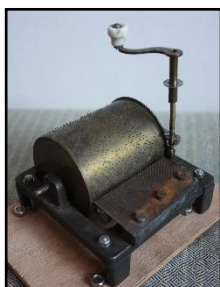
Photo 3. Le mécanisme de la boîte avec son gros cylindre et le peigne.
