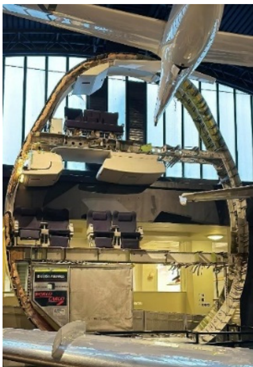
Fig.6. Secțiune prin fuselajul avionului Boeing 747 SP, cu cargo și două etaje de scaune. Numit și Jumbo Jet, Boeing 747 SP a fost introdus în anul 1975 și a revoluționat transportul de pasageri pe distanțe lungi. Este avionul de pasageri subsonic cu cel mai înalt plafon de zbor (13 700 m). În total au fost produse 45 de aeronave, majoritatea fiind retrase în prezent.
